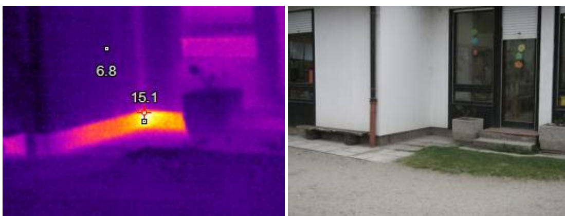
Slika 20: Izgube toplotne energije skozi cokl - vrtec Idrija, enota Spodnja Idrija
